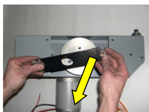
5 Enlever l'étrier du roulement.
