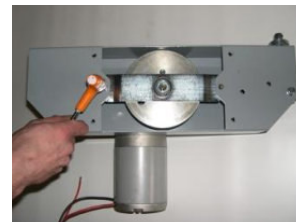
3 Dévisser, avec la même clé hexagonale, les deux vis de l'étrier de renfort de l'arbre moteur.
