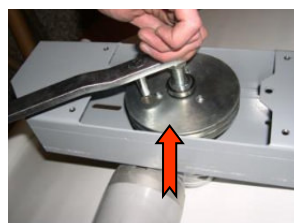
6 Visser la poignée d'urgence au centre de l'arbre en faisant attention à insérer le pivot rond dans le logement approprié.
