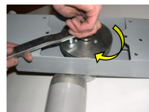
7 Visser à fond la vis de la poignée, en se servant éventuellement d'une clé pour la vis hexagonale.
